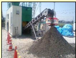
高含水土固化システム
